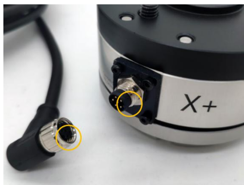
ケーブル接続操作
