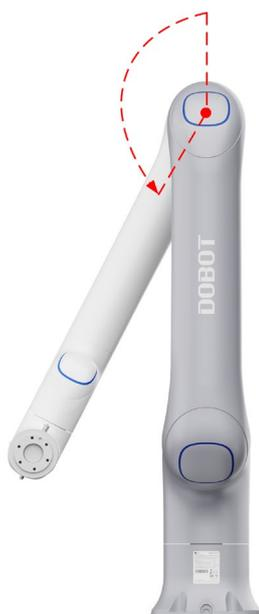
図 3.10 J3 非常停止試験の概略図
