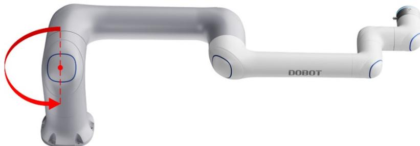
図 3.8 J1 非常停止試験の概略図
