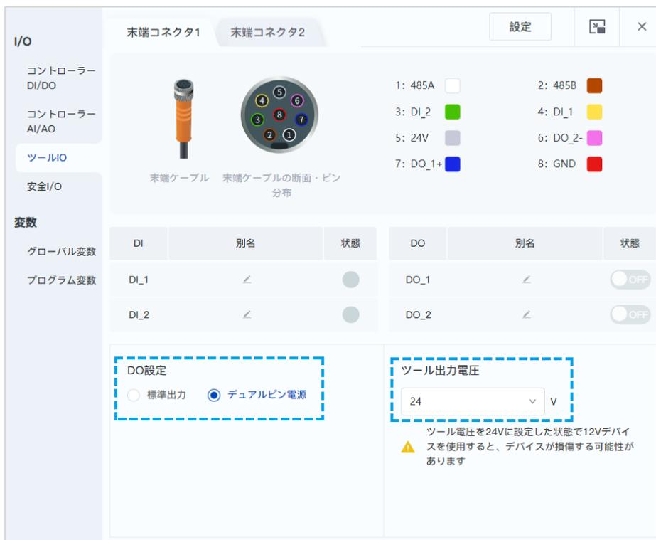
図 5.29 エンド I/O (M8) 配置-デュアルピンモード
