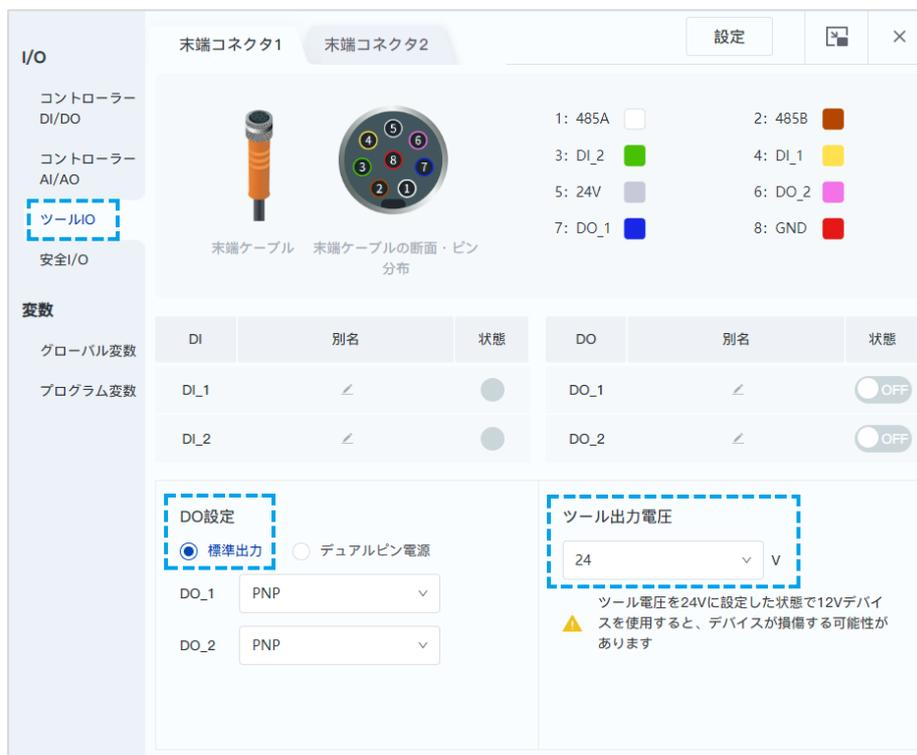
図 5.27 エンド I/O (M8) 配置-シングルピンモード
