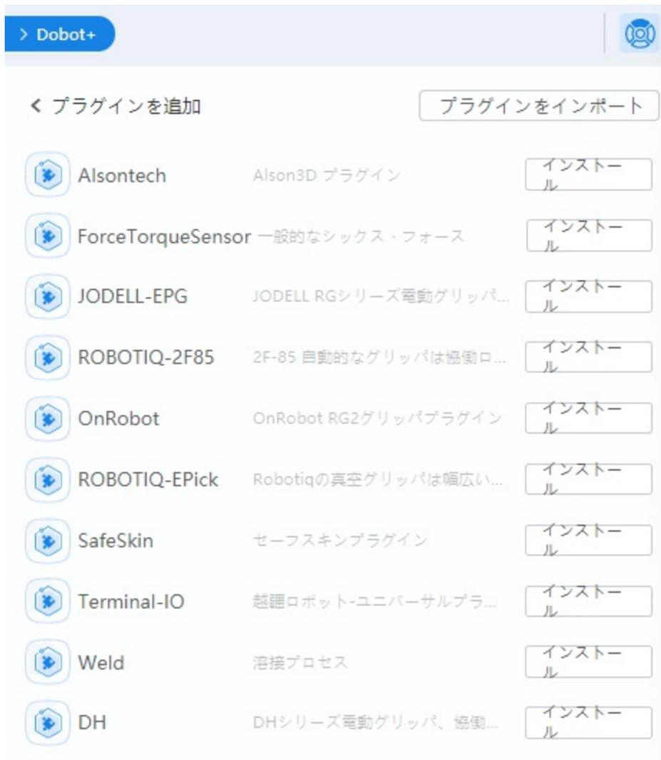
プラグインのインストール完了後に、**Dobot+**のメイン画面に表示されます。対応するプラグインを選択した後、プラグインの基本機能を構成できます。それぞれのプラグインの構成方法は異なります。本文では詳細に説明しません。プラグインアイコンの右上にあるXをクリックすると、プラグインを削除できます。
