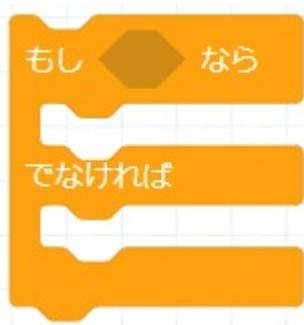
説明：パラメータがtrueの場合、「else」の前のネストにされたブロックインスタクションを実行します。パラメータがfalseの時、「else」の後のネストにされたブロックインスタクションを実行します。
