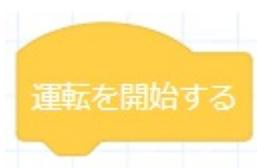
説明：プログラムのメインスレッドの標識です。新しいプロジェクトを作成した後に、プログラミングエリアには実行開始標識があります。その他非イベントブロックをその下に接続し、プログラミングを行ってください。
