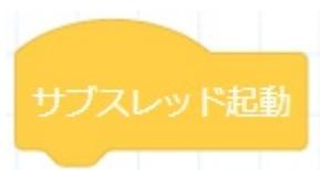
説明：プログラムのサブスレッドの標識です。サブスレッドはメインスレッドと同期して実行します。ただし、サブスレッドはロボットアームの制御コマンドを使用できず、変数演算またはI/O制御などのみを実行できます。プログラムロジックに応じてサブスレッドを使用するかどうかを選択してください。
