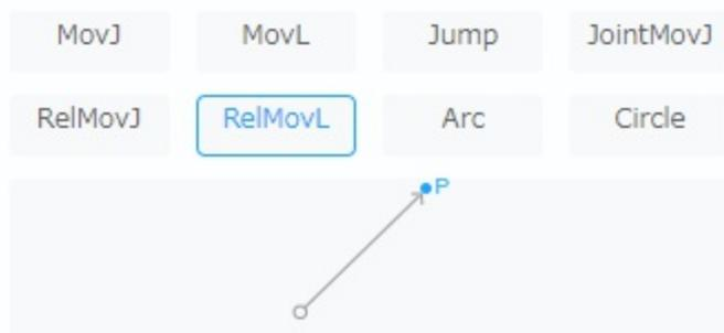
基本設定：デカルト座標系のX軸、Y軸、Z軸方向上のオフセット量。単位：mm。
