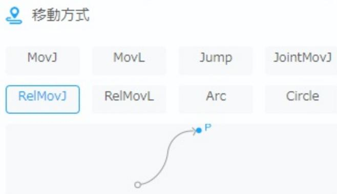
基本設定：デカルト座標系のX軸、Y軸、Z軸方向上のオフセット量。単位：mm。
