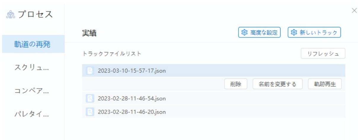
右上隅の「軌跡の新規作成」をクリックし、ロボットアーム先端の指示ランプが黄色常時点灯に変わると、ロボットアーム本体をドラッグすることができます。ドラッグした軌跡は記録され、再現のために使用されます。
