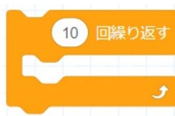
説明: その他のブロックをこのブロックの中間にネストにすると、ネストにされたブロックのインストラクションが指定された回数繰り返し実行されます。
