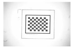
図 6.1.2 視野の中心にあるキャリブレーションプレート
