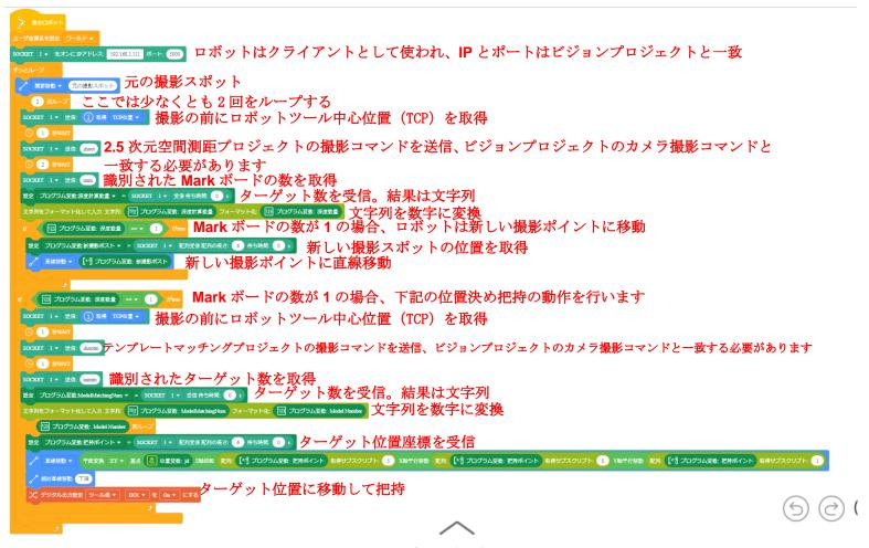
図 9.5.7 ロボットプログラム
