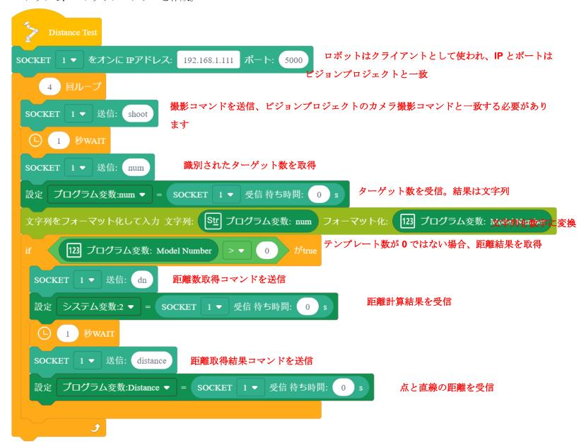
図 9.2.5 ロボットプログラム
