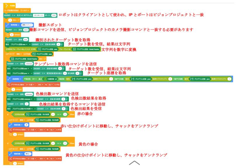
図 9.3.7 ロボットプログラム
