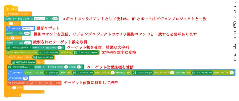
図 9.1.7 ロボットプログラム - N 点キャリブレーション
